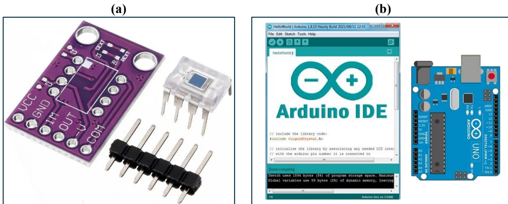
Figura 5.4: Coleta e análise em tempo real dos padrões de transmissão óptica. (a) Sensor de iluminação OPT101 que integra um fotodiodo e um amplificador. (b) Software Arduino IDE e microcontrolador Arduino Uno R3.
