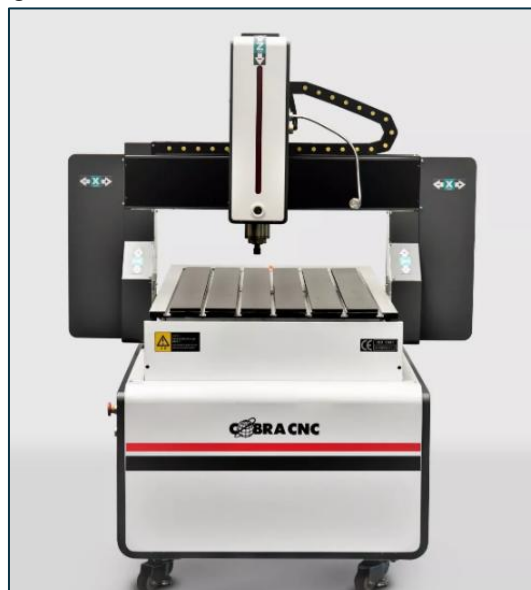
Figura 4.18: CNC Router COBRA, modelo RC6090.
