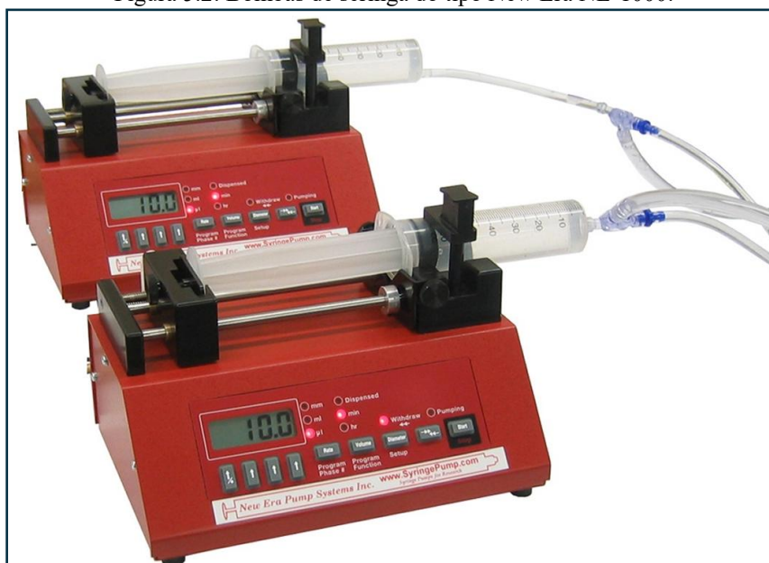
Figura 5.2: Bombas de seringa do tipo New Era NE-1000.
